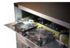
风扇冗余设计,提升系统可靠度
